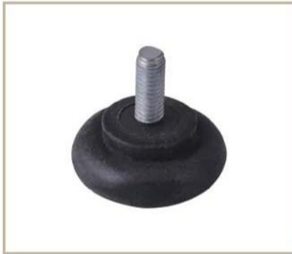
M06000013 Ürün No/Prod.No:344 BİNGO AYAK BÜYÜK CİVATALI BİNGO FOOT BIG SCREWED A: 54mm B: 30mm C:3/8
